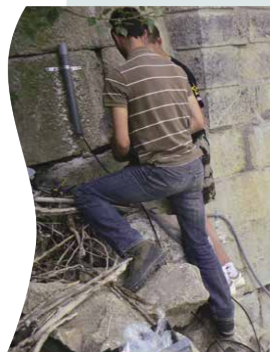
Pose d'une sonde temporaire de mesure de débit dans le Buëch
